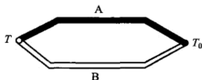
图 2-25 热电偶结构示意图
