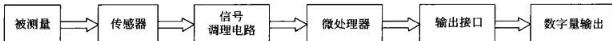
图 2-38 智能传感器结构框图
