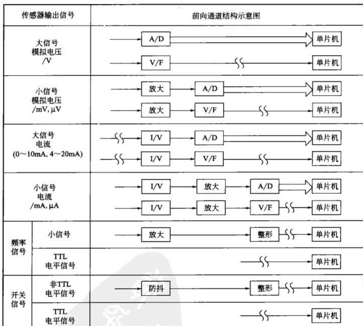
图 4-1 前向通道结构示意图
