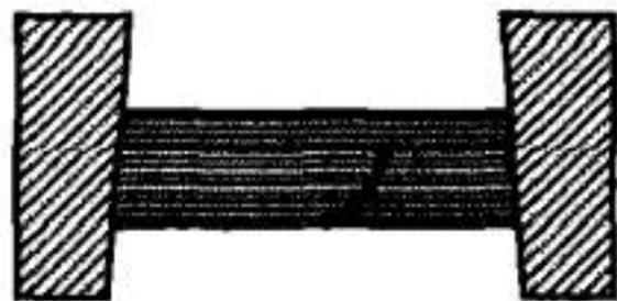
图 2-28 裂纹探测应变计
